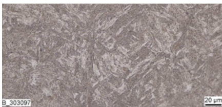
Angelassener Zustand, Ölabbkühlung
