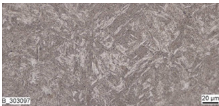
Angelassener Zustand, Ölabbkühlung 200:1
