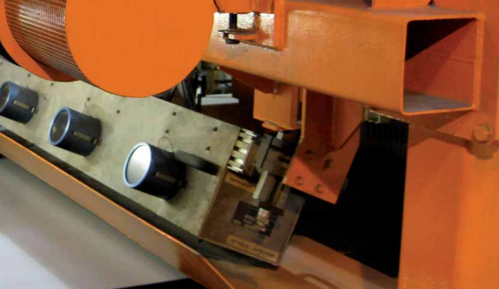
▲ Automatisiertes Auge Oberflächeninspektionssystem überwacht Bandoberfläche
