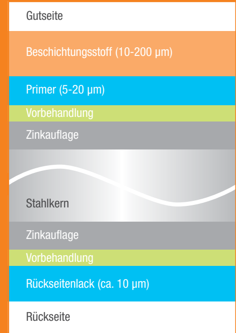
Schematischer Aufbau von FOLASTAL®
