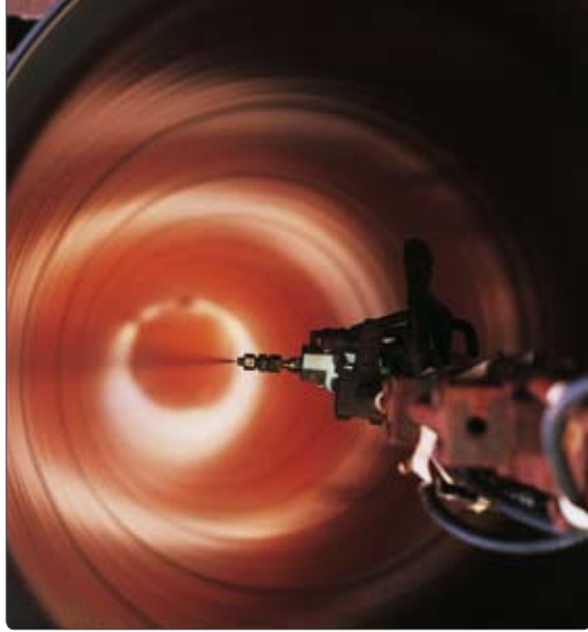
Einer der finalen Fertigungsschritte der Rohrherstellung ▲ Aufbringen der Kunststoffinnenbeschichtung
