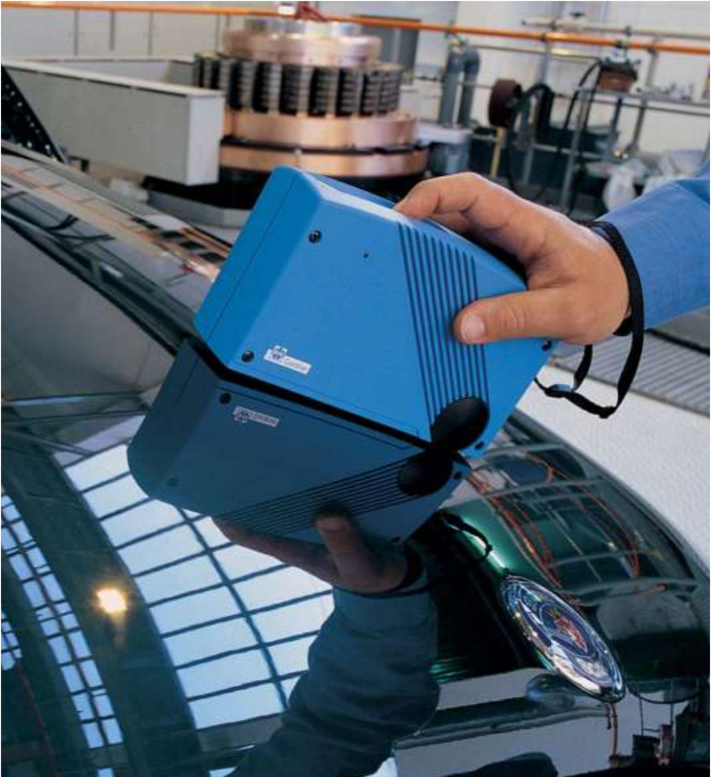
Ermittlung der optischen Lackeigenschaften mit Hilfe eines Wave-Scan-Gerätes Determination of optical painting characteristics by mean of a wave-scan-device Définition des propriétés optiques du laquage à l'aide d'un appareil « Wave-scan »
