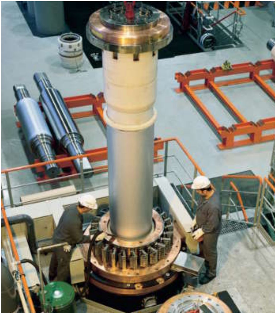
Walztexturierung in der PRETEX®-Anlage
