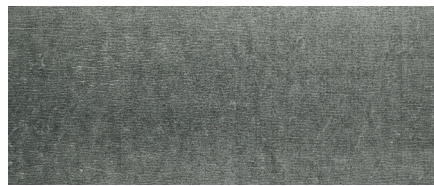
Abbildung 1: Passivierte Probe nach 504h DIN EN ISO 6270-2 AHT. Weißrostanteil < 1%.
