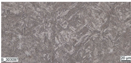
Angelassener Zustand, Ölabbkühlung 200:1
