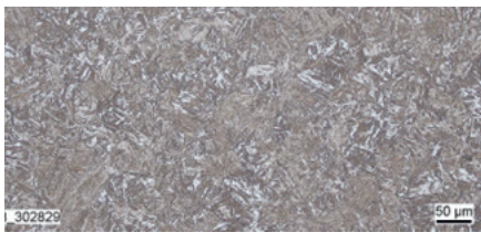
Gehärteter Zustand, Wasserabkühlung 200:1
